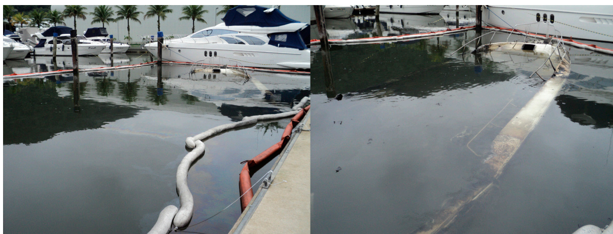
Foto 5.8 – Embarcação naufragada em marina no Canal da Bertioga cercada por barreiras para reter espalhamento da mancha de óleo (Fonte: CETESB).
