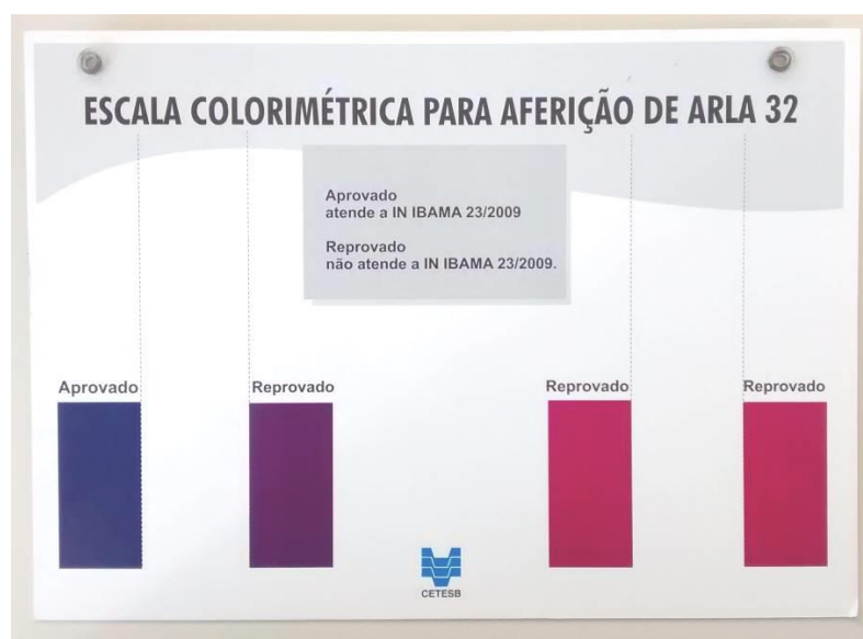
Figura 3 - Escala Colorimétrica para aferição de ARLA 32
