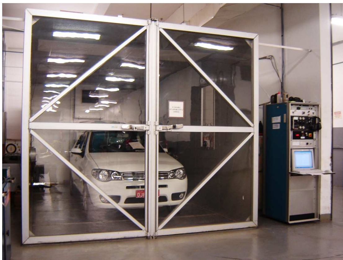
Figura 6 - Veículo inserido para ensaio de emissão evaporativa na câmara SHED do laboratório de Emissão Veicular da CETESB em São Paulo
