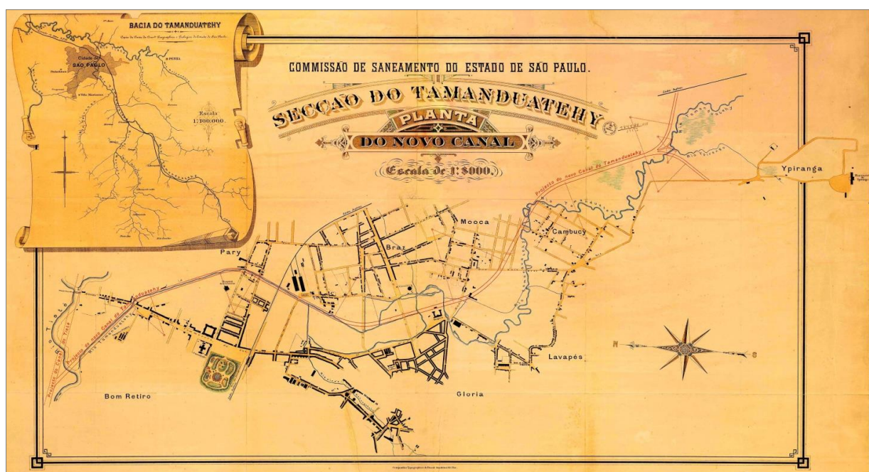
Figura 4: Projeto de canal de retificação do rio Tamanduateí (em vermelho). 1925.
