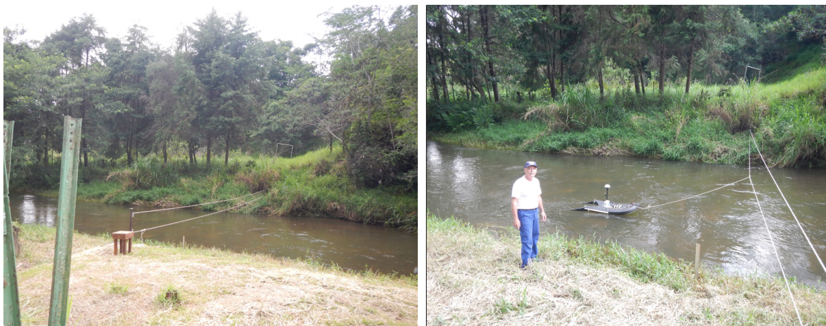
Figura 3.4 – Ex. Medição de vazão realizada pela CETESB no ponto UAMA 00600, no Rio Piracuama, Vale do Paraíba. (Foto: C.Midaglia).
