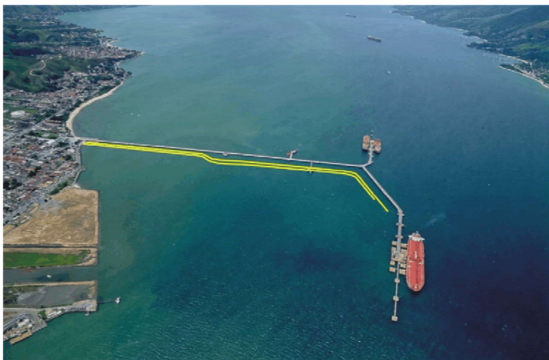
Figura 4.4. Disposição das linhas do emissário submarino do Tebar (Fundespa, 2003)
