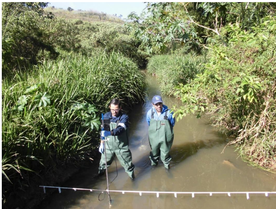
Figura 6 – Exemplo de Medição de vazão a vau realizada pela CETESB na Ponte na entrada da portaria 2 do Parque Estadual do Juquery, em Franco da Rocha
