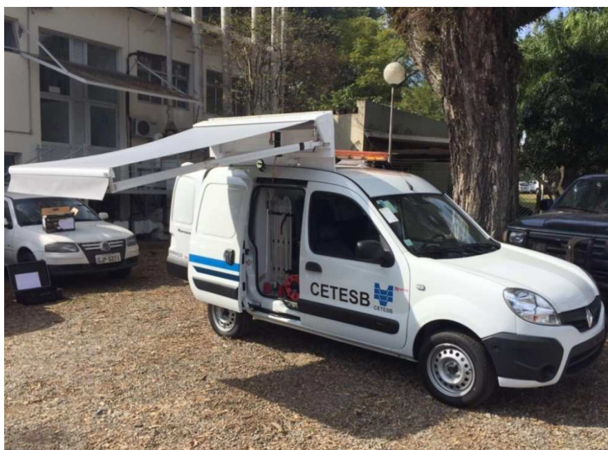
Figura 9 - Unidade móvel de fiscalização equipada com opacímetro
