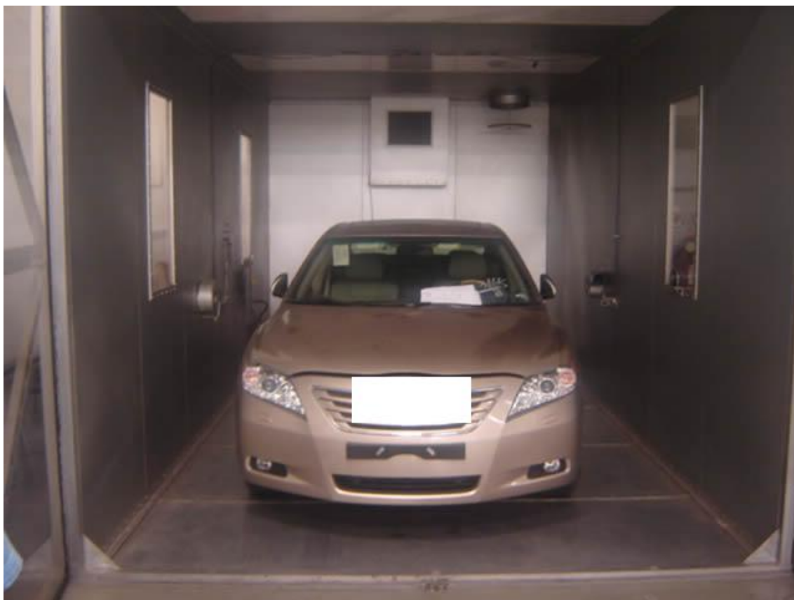
Figura 5 - Veículo inserido na câmara SHED do laboratório de Emissão Veicular da CETESB em São Paulo.
