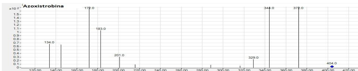
Figura 1. Espectros de massa dos 21 agrotóxicos analisados por LC-MS/MS
