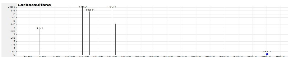
Figura 1. Espectros de massa dos 21 agrotóxicos analisados por LC-MS/MS (Continuação)
