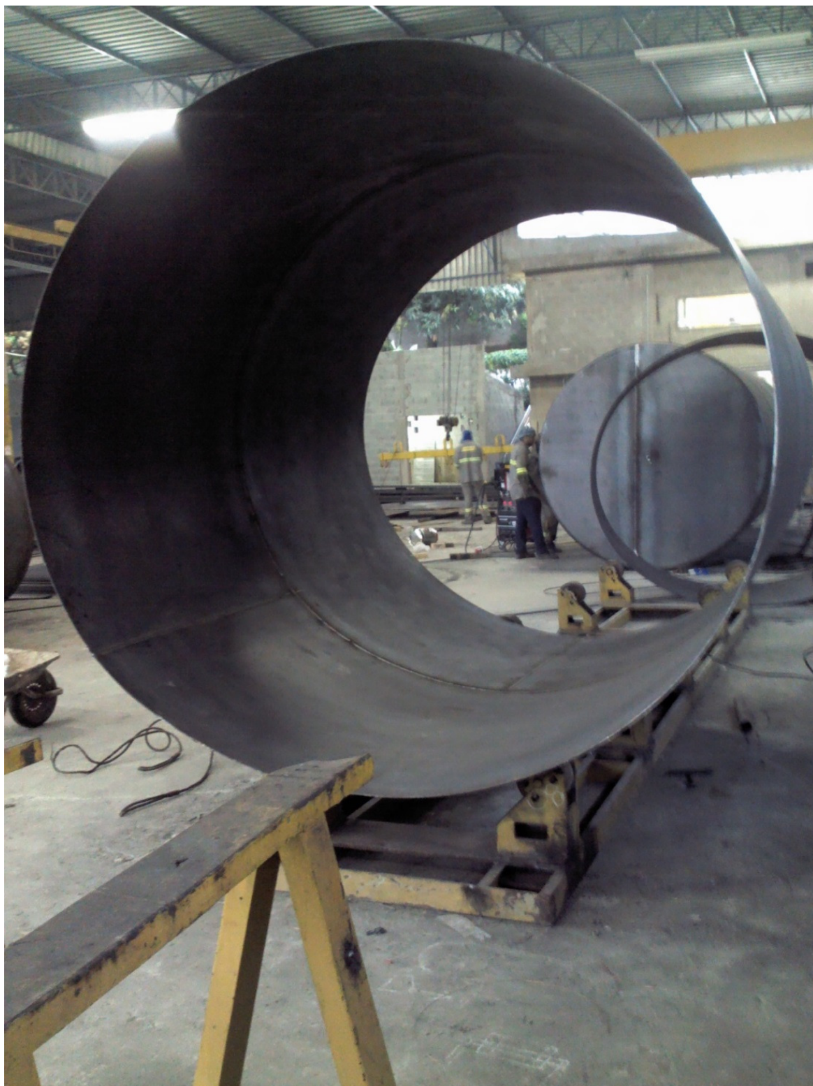
Figura 33 - Chapa de aço-carbono utilizado na fabricação dos tanques de parede dupla. Fonte: Autor (13/01/2014).
