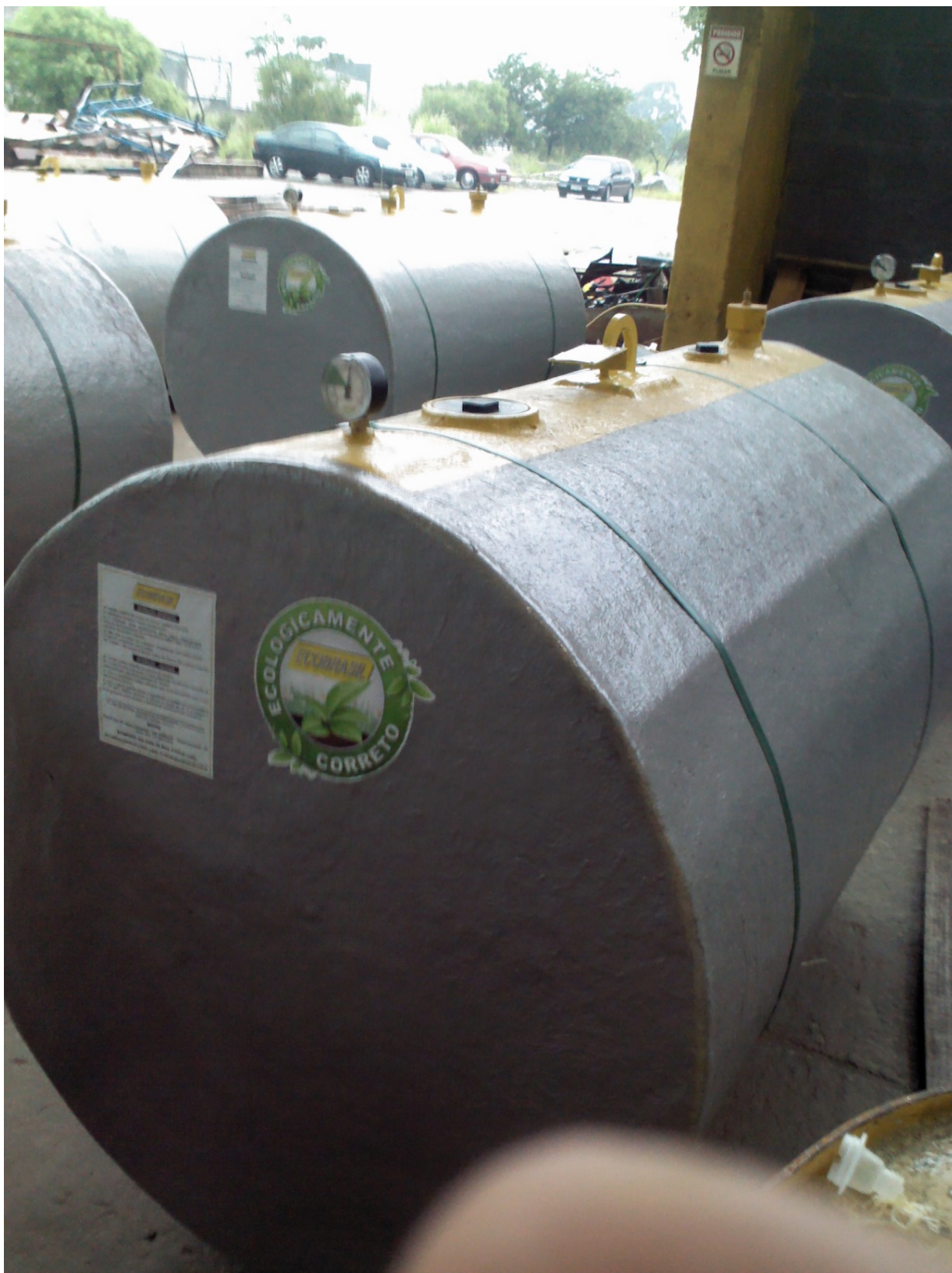
Figura 35 - Tanque de parede dupla para óleo queimado. Fonte: Autor (13/01/2014).
