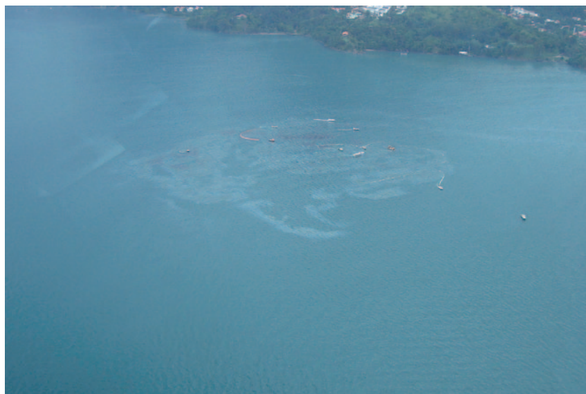
Foto 5.13 – Manchas de óleo prateadas e iridescentes sendo removidas com utilização e barreiras absorventes.
