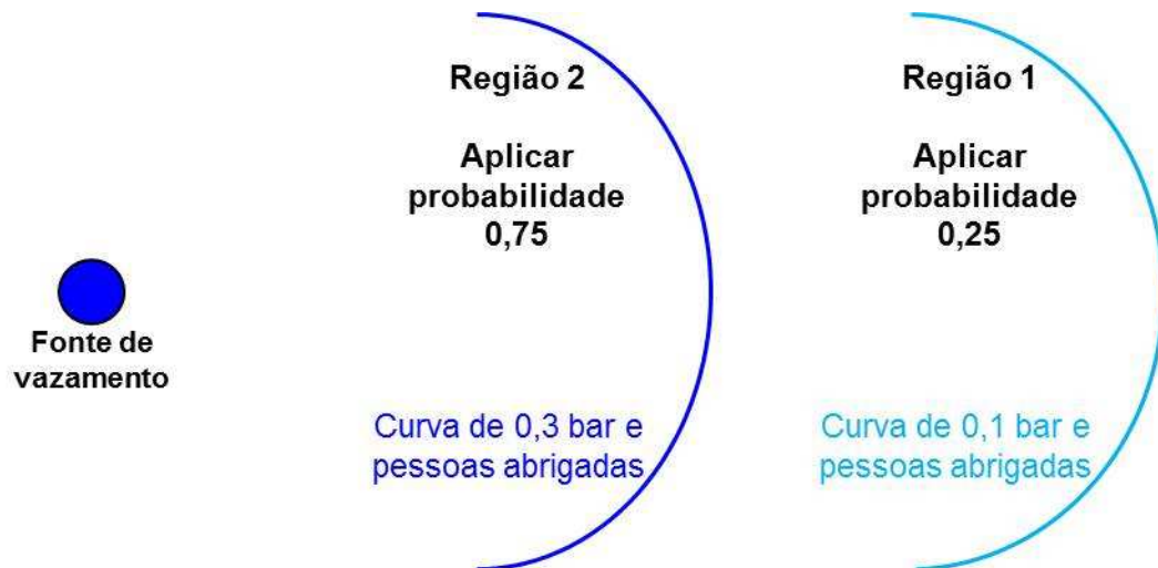
Figura 4 - Representação das regiões de probabilidade de fatalidade associadas aos valores de referência para o efeito de sobrepressão
