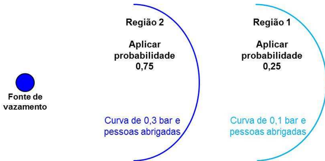
Figura 13 – Representação das regiões de probabilidade de fatalidade associadas aos valores de referência para o efeito de sobrepressão
